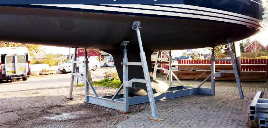
Monteret med ekstra ben og kædesikring
