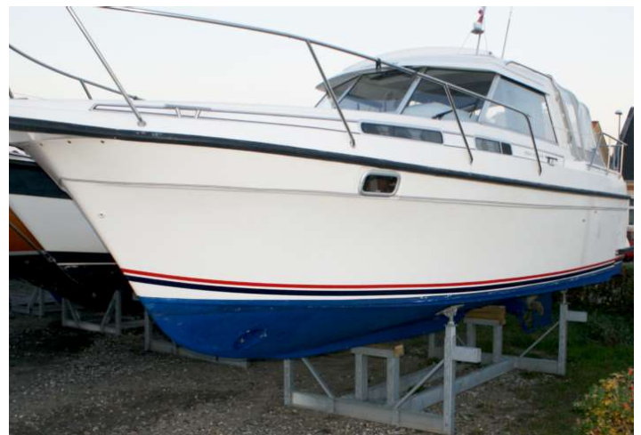
6 Ton mobilt bådstativ m/2 motorbådsbukke (Benhøjde 900 mm)
