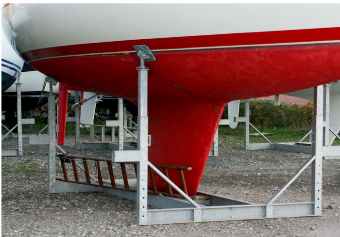
6 Ton mobilt bådstativ (Benhøjde 1200 mm)
